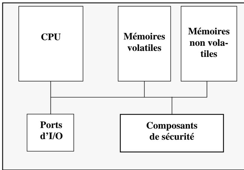
Tab. 4.1 - Modèle d'architecture du micro-circuit ST19SF16F
