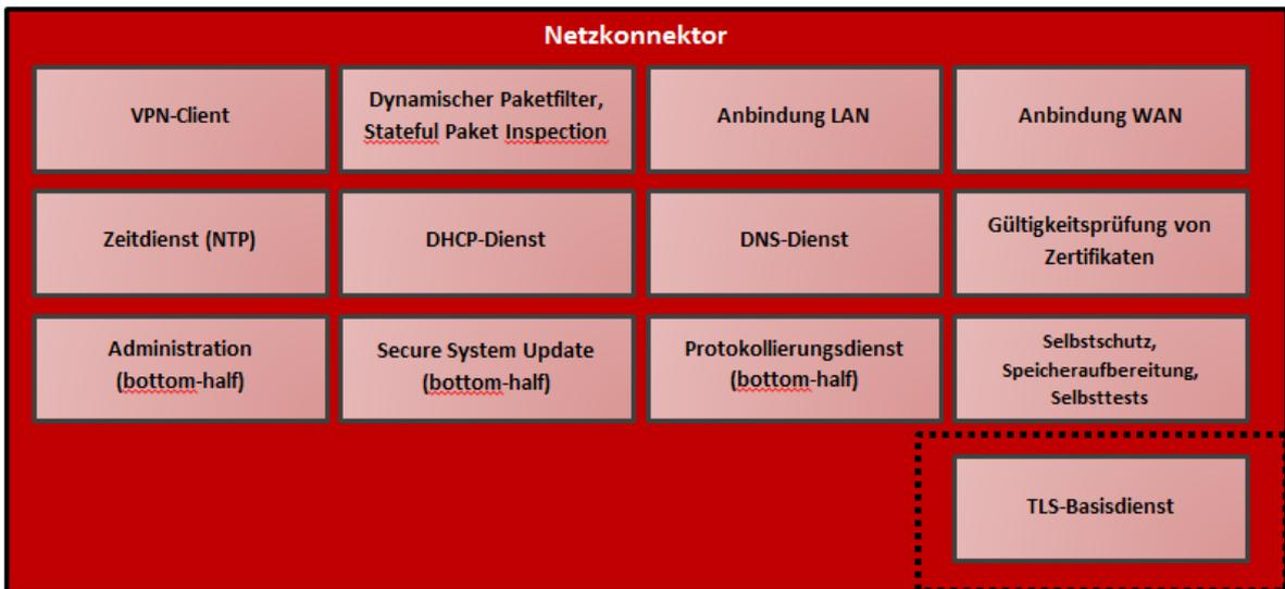
Abbildung 6: Netzkonnektor Komponenten (Der TLS-Basisdienst wird im Anwendungskonnektor umgesetzt, ist aber formal dem Netzkonnektor zugeordnet)
