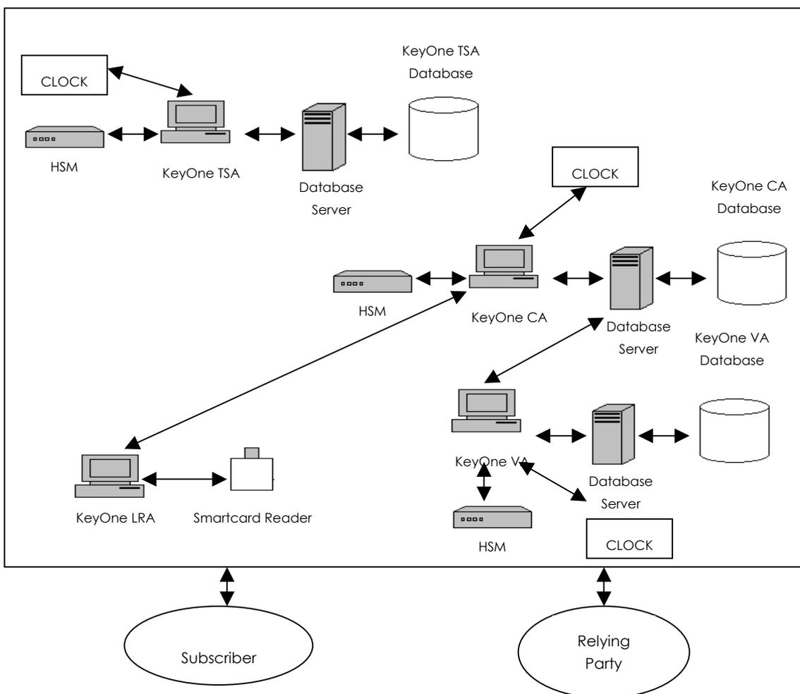
Figura 2.5: Arquitectura Física del KTS
