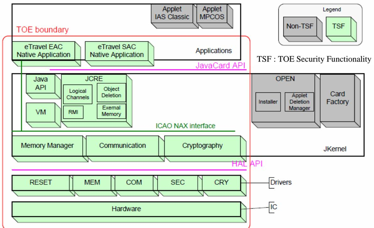
Figure 1 - Architecture et périmètre de la TOE
